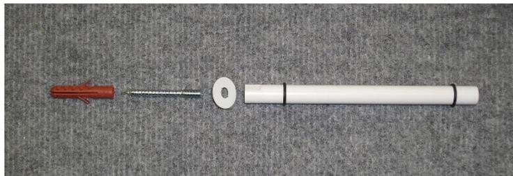
Sie können die Schraube in den Dübel drehen (Torxspitze notwendig) oder die Schraube erst mit dem Halter verbinden und dann beides per Hand in den Dübel eindrehen.
